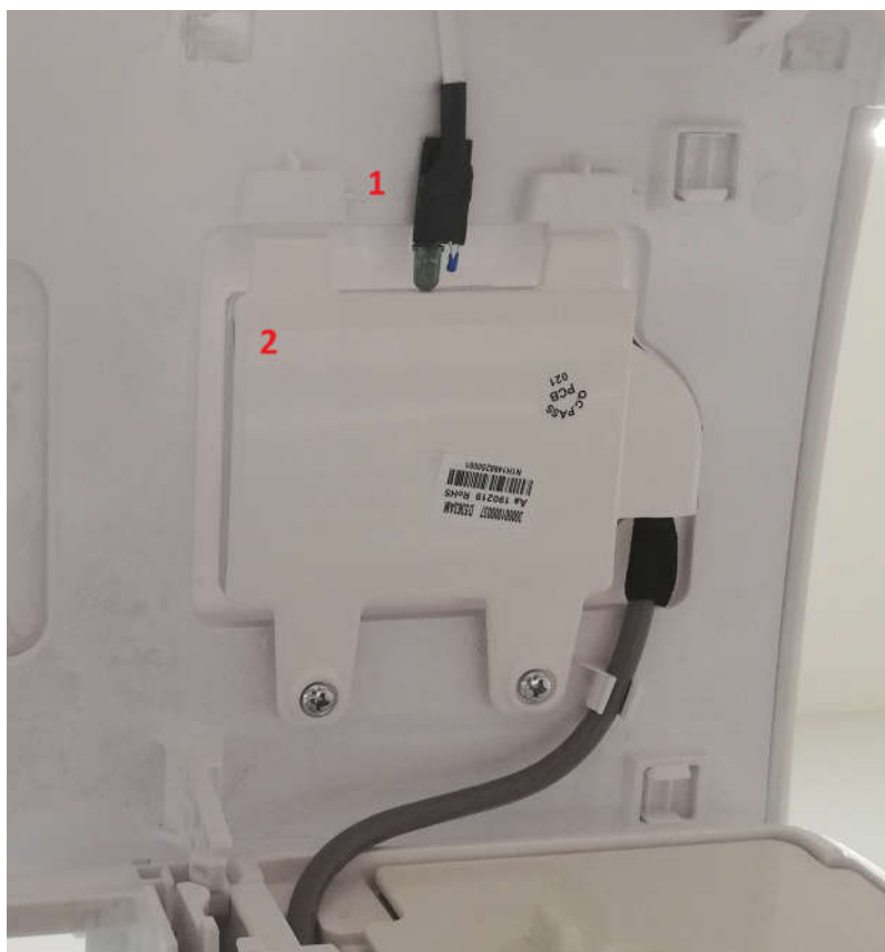
Obr. 3 Umístění SC05010 u displeje vnitřní jednotky – pohled na vnitřní stranu čelního krytu
